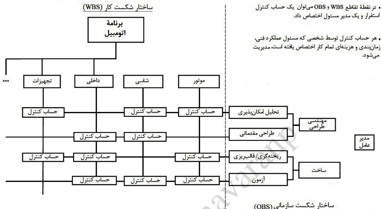
شکل ب-۴- ساختار شکست سازمانی (OBS)، ساختار شکست کار (WBS) را قطع می‌کند.
