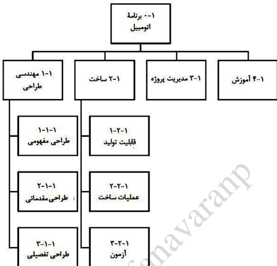
شكل الف-۲- ساختار شکست کار- مثالی برای برنامه اتومبیل (مثال «گرافیکی» و «کارکردگرا»)
