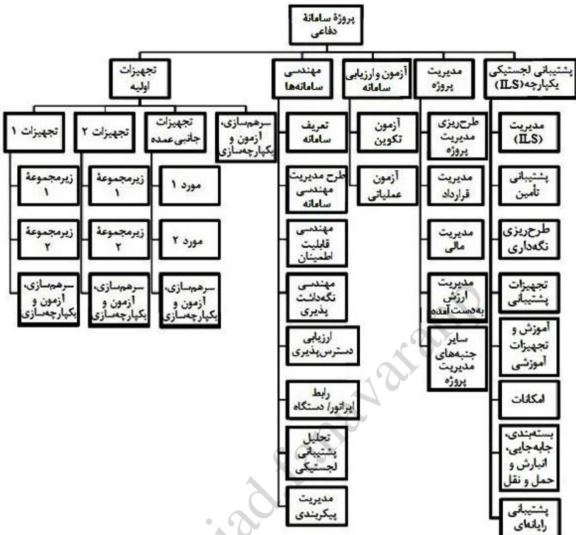
شكل الف-۴- ساختار شکست کار- مثالی برای پروژه سامانه دفاعی (مثال «گرافیکی» و «محصول‌گرا و کارکردگرا»)
