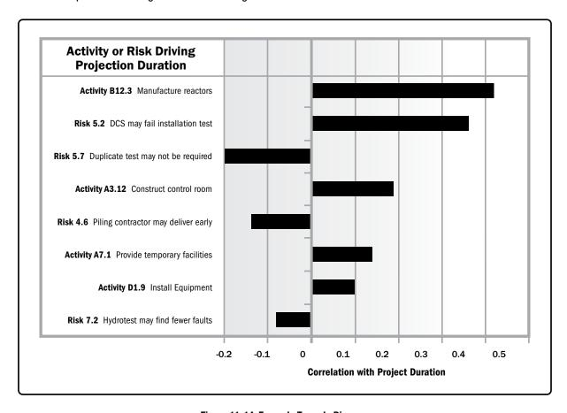
Figure 11-14. Example Tornado Diagram
